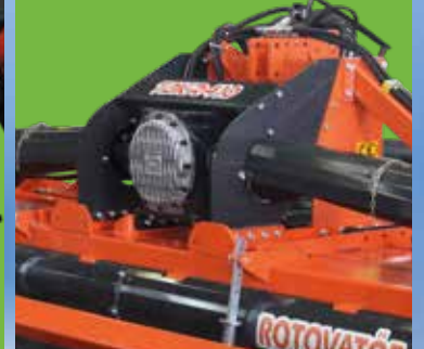
Çift hareket sistemine sahip hızlı ve normal devirli şanzıman
